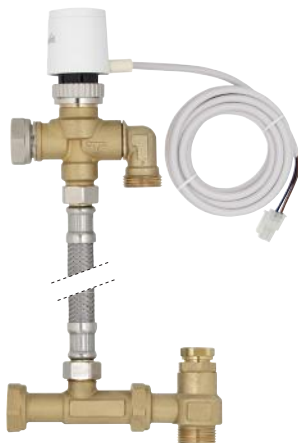
3-potni ventilski sklop 3-potni ventilski sklop, sestavljen iz: 3-potni ventil s kalibriranim premerom za odklon, zaporni ventil, odvodni priključek, fleksibilna cev, predoblikovane izolacijske lupine za ohišje in držalo ventila, elektrotermična glava (ON / OFF 230V ~) normalno zaprto.
